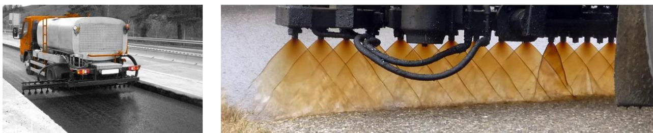
Figure 3 : Exemple de : a) Répandeuse ; b) Application de l'émulsion
