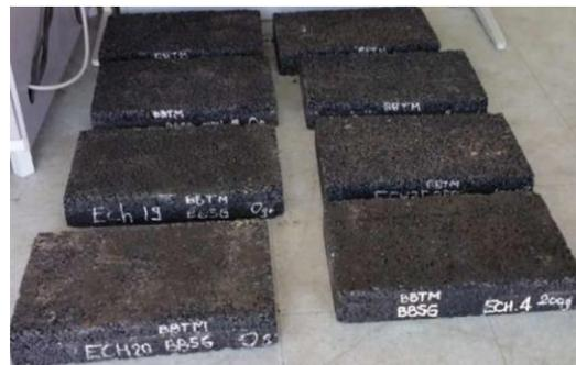
Figure 17 : a) Echantillon réalisé pour une estimation de la permittivité diélectrique du minéral de la Roche Guillaume ; b) Exemple de dalles bicouches fabriquées
