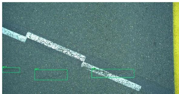
*Détection exacte de dégradations (TC)*
