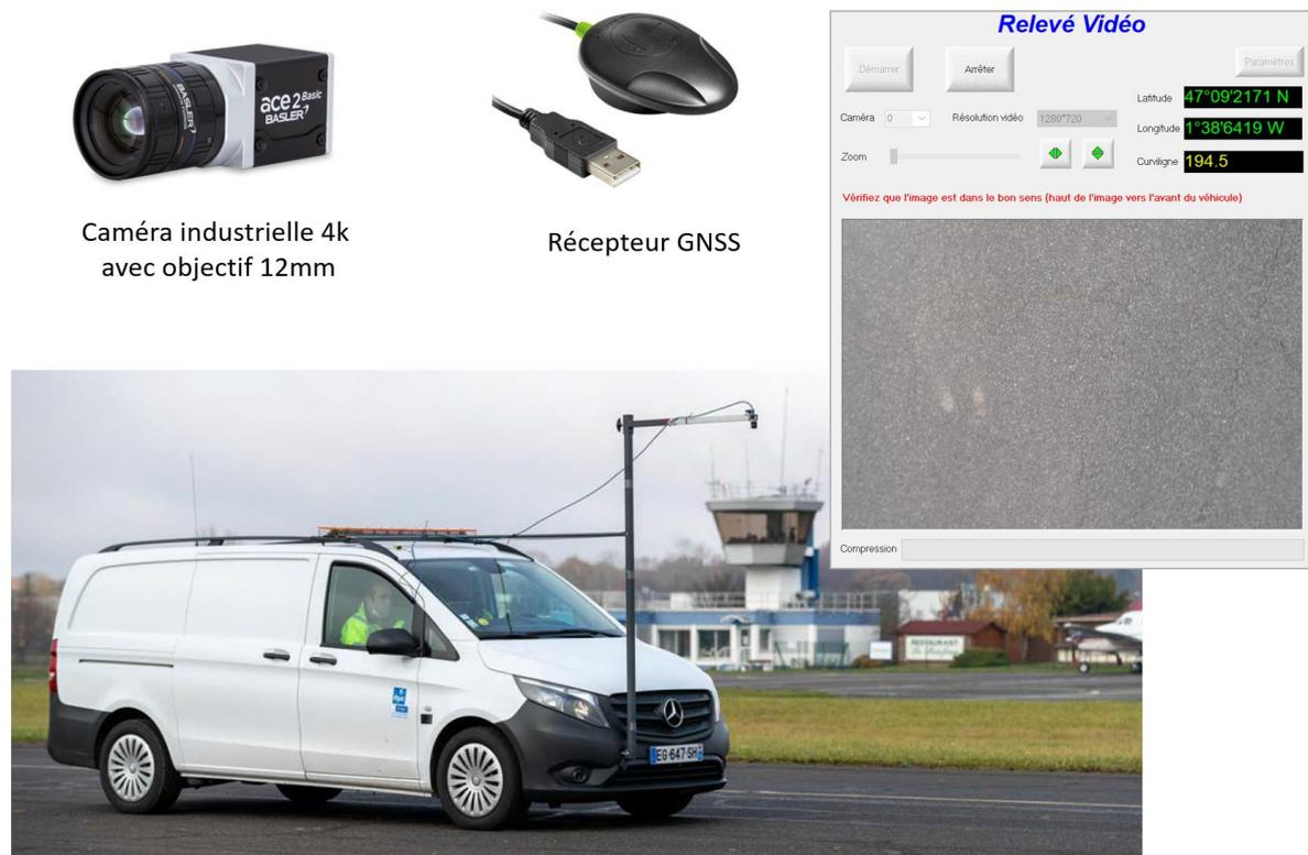
Figure 4. Vue de l'instrumentation montée sur le véhicule porteur et utilisée pour la prise d'images
