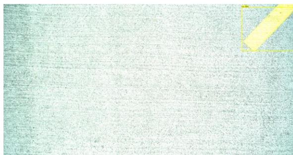
*Détection erronée de dégradation*
