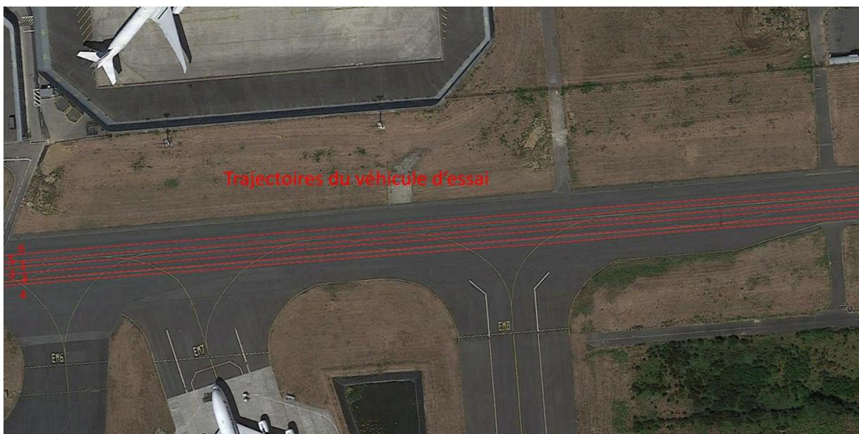
Figure 22. Vue des trajectoires suivies par le véhicule d'essais sur la piste Mike
