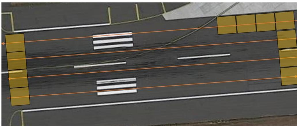
Figure 2. Schéma illustrant le balayage à réaliser pour la collecte d'images
