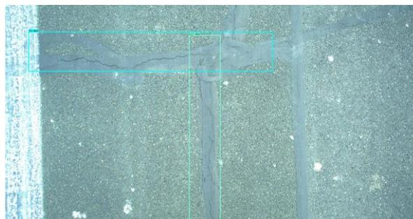
*Détections exactes de dégradations (fissures multiples)*
