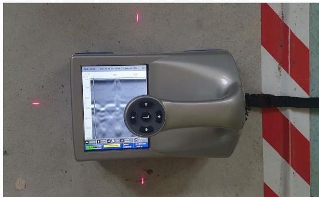
Figure 9 : radar portable utilisé pour l'acquisition des données GPR sur les poutres et le pont.
