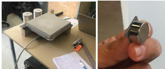
Figure 1. Configuration expérimentale avec un nœud de mesure NEURON (image de gauche) en mode interrogateur magnétique en surface couplé à 2 dalles en béton calibrées avant le positionnement du capteur magnétique (image de droite).
