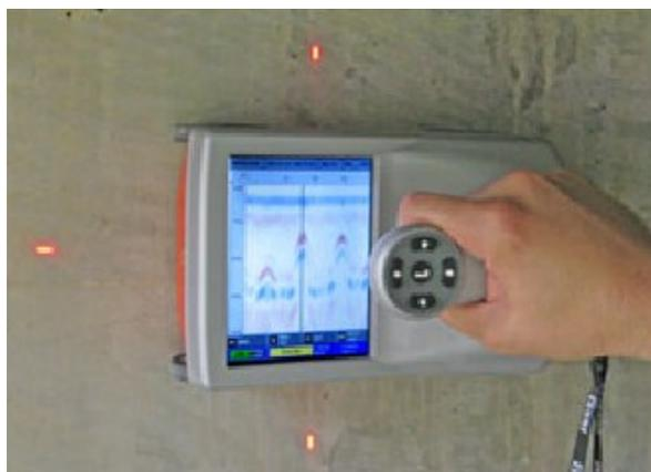
Figure 5. a) Matériel radar SIR4000 (GSSI) associé à une antenne 1,5 GHz, b) Matériel radar StructureScan (GSSI) travaillant à 2,6 GHz
