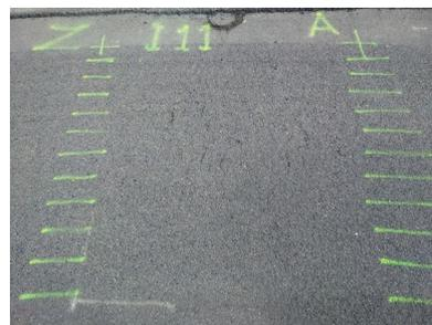
Figure 16. Evolution des dégradations superficielles du défaut I11 à 310, 500 et 720 kchgts
