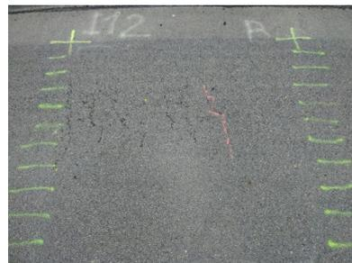
Figure 17. Evolution des dégradations superficielles du défaut I12 à 310, 500 et 720 kchgts
