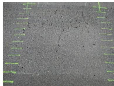
Figure 18. Evolution des dégradations superficielles du défaut I13 à 310, 500 et 720 kchgts
