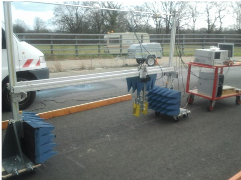
Figure 4. Banc de mesure radar supportant deux antennes ultra-large bandes, reliées à un analyseur de réseau (chariot de droite); l'ensemble étant piloté par un micro-ordinateur
